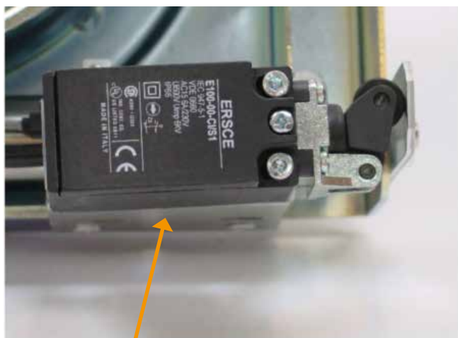
Microdisjuntor fixado na placa de regulação.
