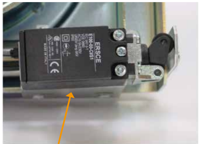
Am Schieber befestigter Mikroschalter
