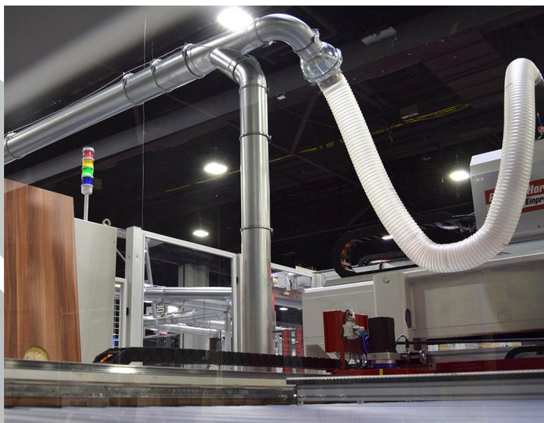
Au dessus de: Un joint à rotule QF est illustré dans une ligne de conduit QF installée sur des machines à bois. Nordfab propose une gamme complète de flexibles PU.
